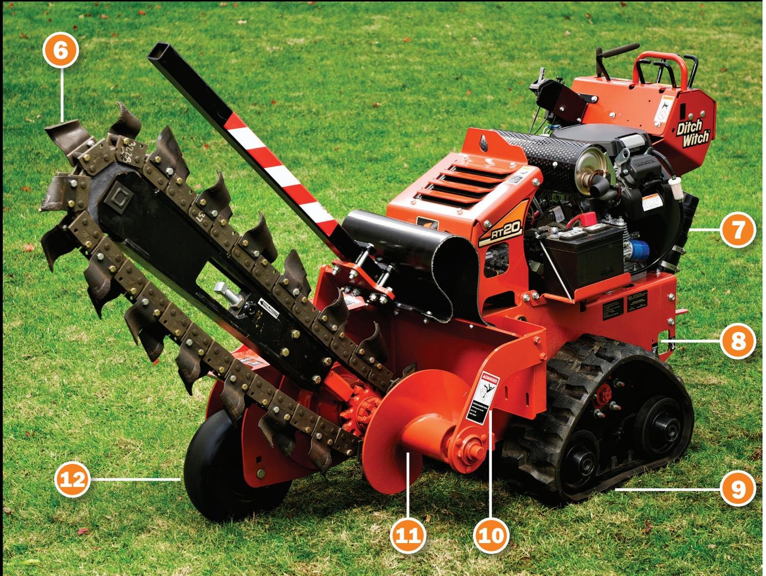
7. Los modelos RT12, RT20 y RT24 están equipados con motores duraderos y de bajo mantenimiento marca HONDA®, líder mundial en la fabricación de pequeños motores del tipo OHV; mientras que el modelo RT16 está equipado con el confiable y económico motor Briggs & Stratton® Vanguard™
