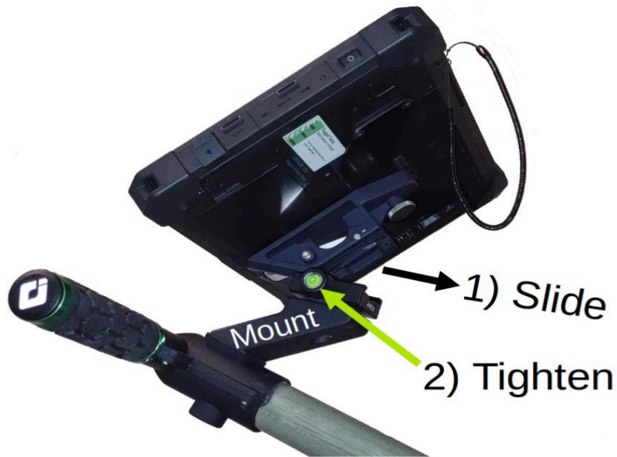
Figura No.6 TABLETA COLOCADA SOBRE SOPORTE
